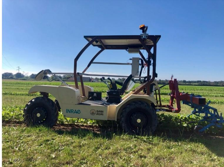
*Das Ziel von LabCom TIARA ist es, die Entwicklung einer Steuerarchitektur für die ALPO-Elektrotraktoren von SABI AGRI zu beschleunigen, die autonomes Arbeiten in Interaktion mit Menschen ermöglicht.*
