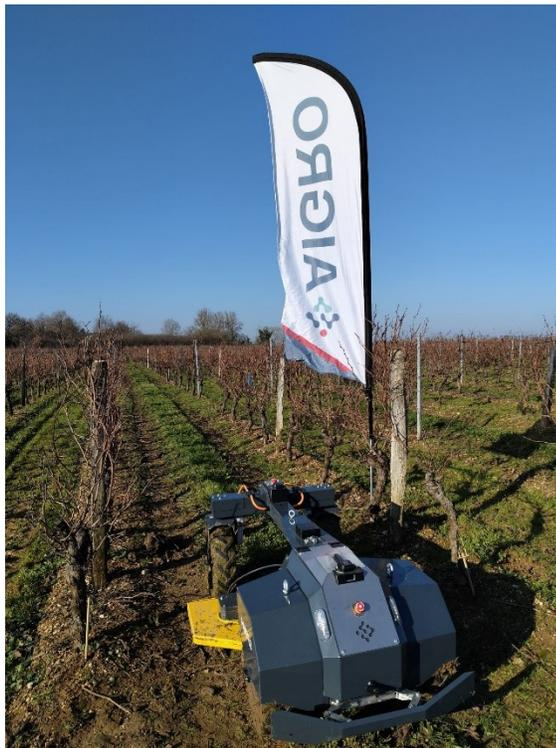
*Der AIGRO UP ist ein autonomer, flexibler und äußerst robuster Geräteträger, der für verschiedenste Aufgaben eingesetzt werden kann – darunter Mähen, Striegeln, Monitoring (Scouting) oder weitere, kundenspezifisch integrierbare Funktionen.*
