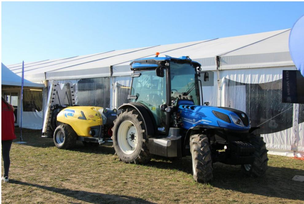
*New Holland war Partner der 2025 World FIRA und präsentierte den T4.120F mit dem Advanced Vision Assisted Guidance System. Dieses System nutzt einen LiDAR-Sensor, der am vorderen Dachmittelpunkt der Kabine montiert ist, um das automatisierte Lenken zu ermöglichen.*
