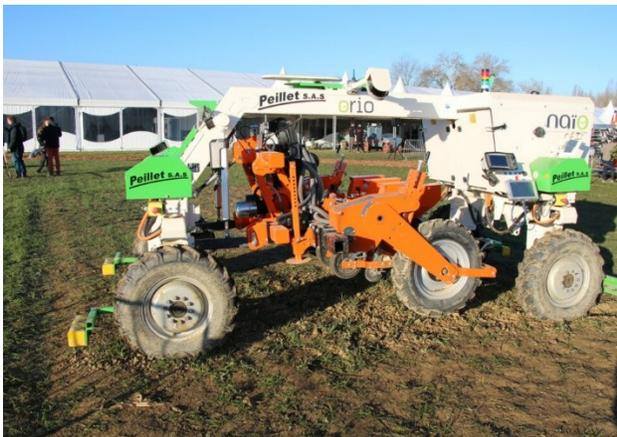
*Naïo Orio ist mit einer Stanhay Präzisionssämaschine ausgestattet.*
